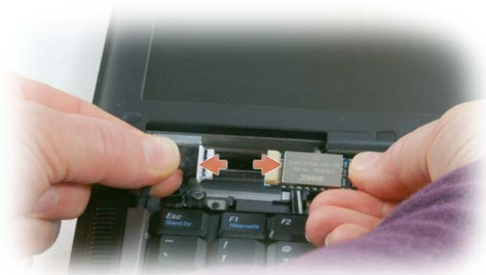
6 拔下插卡的纜線，然後從電腦中取出插卡。
