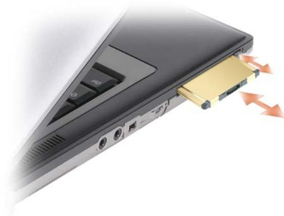
電腦能夠識別大多數 PC Card，並自動載入相應的裝置驅動程式。如果組態程式提示需要載入製造廠商提供的驅動程式，請使用 PC Card 隨附的軟碟或 CD。
